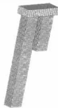
图7 桩-承台-桩有限元模型
