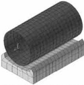
(c) 完成管片拼装, 形成衬砌支护
