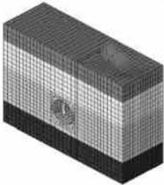
(b) 开挖隧道成“毛洞”, 释放25%载荷
