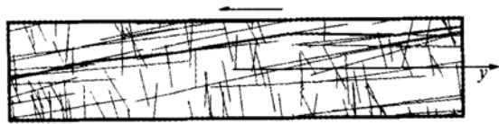
图中黑粗线为剪切路径, 连通率 K = 100\%
