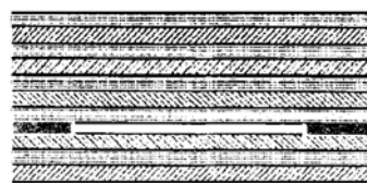
图1 开挖工程岩体等效介质模型
