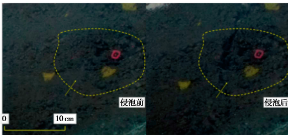
图 6 库水升降对坡体内部侵蚀效应细观表征
