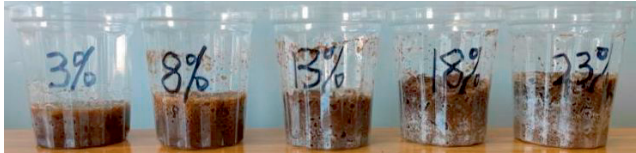
图 4 渗透性高聚物和不同含水率土等质量混合后产物
