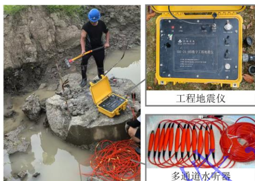
图 8 现场单孔管波法检测图片
