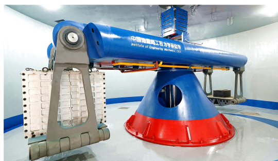
图 1 DCIEM-40-300 型离心机振动台系统
