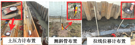
图 5 现场传感器布置 Fig. 5 Field layout of sensors
