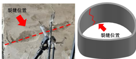
图 7 复合式衬砌 (竖向荷载 370 kPa)
