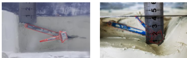
(a) 锚质量 12.3 t, 土强度 10 kPa (b) 锚质量 23.4 t, 土强度 5 kPa
