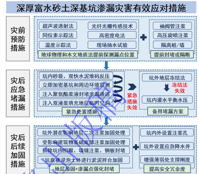
图 12 富水砂土深基坑地连墙渗漏灾害处置措施总结
