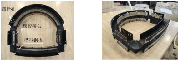
(a) 正视图 (b) 斜视图 图 19 管道隧道衬砌抗错断柔性接头模型
