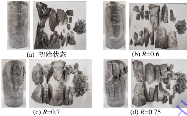
图 9 不同工况作用后灰岩单轴压缩破坏形态
