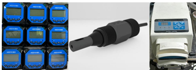
(a) 电导率仪 (b) 电导率探头 (c) 蠕动泵
