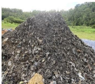
图 8 旋挖钻垃圾样现场图 Fig. 8 Large-diameter rotary drilling waste samples
