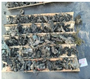
图 7 小钻孔垃圾样现场图 Fig. 7 Small borehole waste samples
