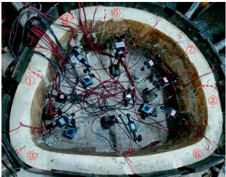
图 9 衬砌试件破坏图
