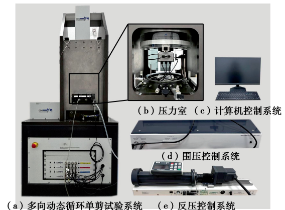
图 1 多向动态循环单剪试验系统 (MDDCSS)
