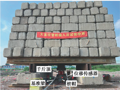
图 4 静载试验加载方法
