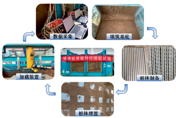
图 2 桩网复合地基模型试验过程
