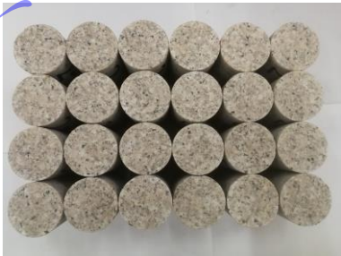
图 1 原状花岗岩试样展示图 Fig. 1 Untreated granite specimens
