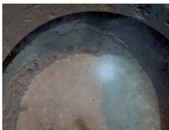
(a) 拱顶板裂后形成凹坑
