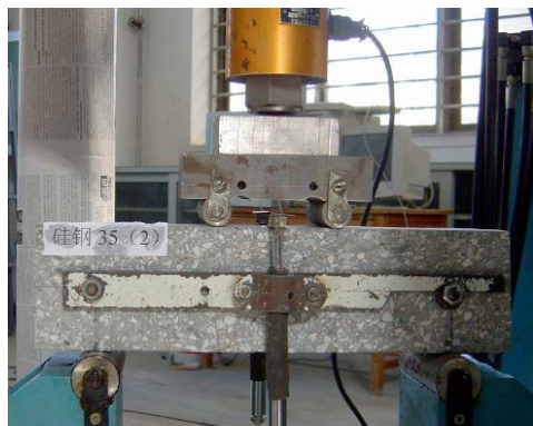
图 5 弯曲韧性试验
