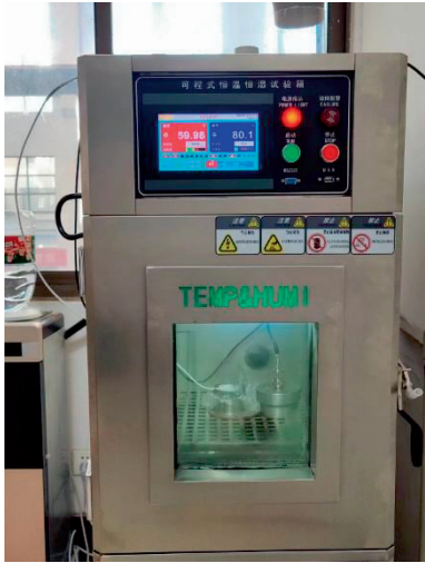
图 3 内置样品的恒温恒湿控制箱
