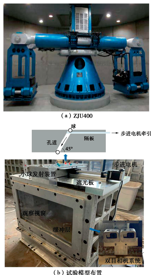
图 1 ZJU400 土工离心机及试验模型布置
