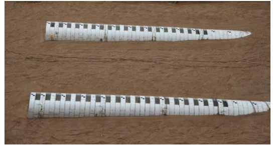
图 5 顶部开洞隧道拼装示意图
