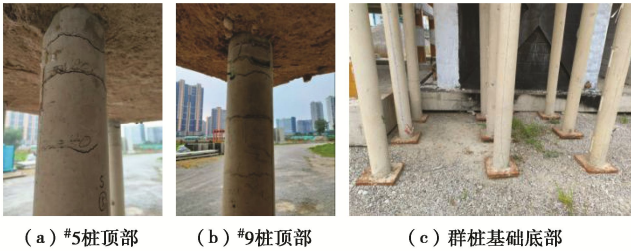
图 6 试验后群桩基础破坏情况
