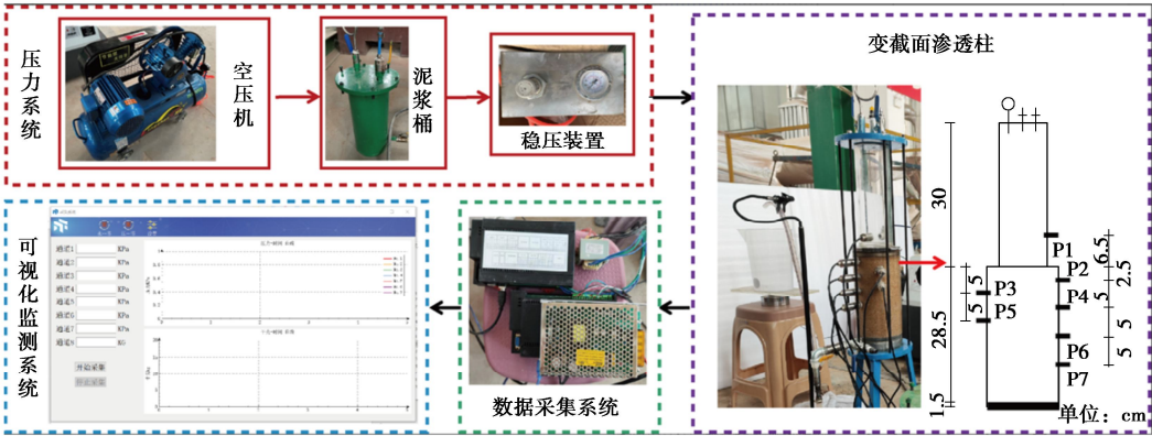
图1 变截面渗透试验系统
