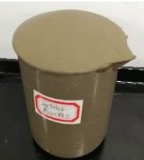
图 2 制备好的水泥土试样（东营港软土， a_w=14\% ） Fig. 2 Prepared cement soil sample (soft soil of Dongying Port, a_w=14\% )
