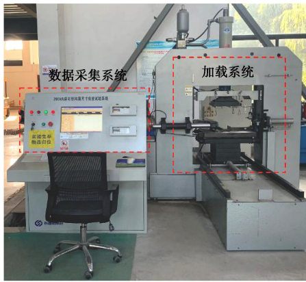
图5 结构面抗剪强度尺寸效应试验系统
