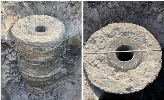
图 18 碳化复合桩开挖检验
