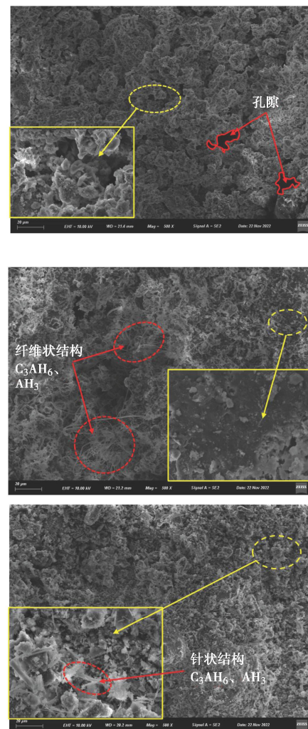
图 5 原灰、固化飞灰和老化 104 a 后的 SEM 图像
