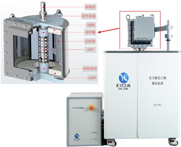
图 2 基于全表面变形测量系统的三轴试验仪
