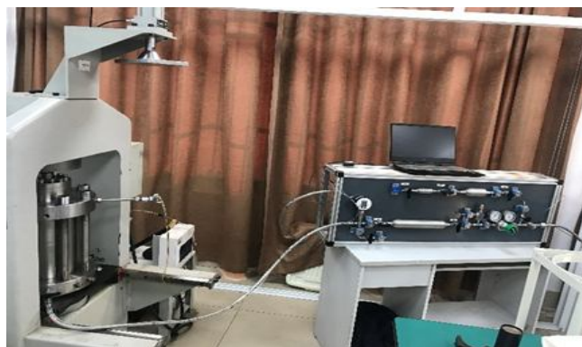
图 2 低渗透岩石气体渗透测试系统
