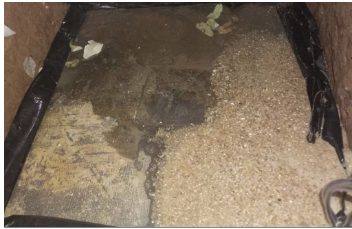
图 6 现场液化试验后的饱和砂实景 (Test-H 工况)
