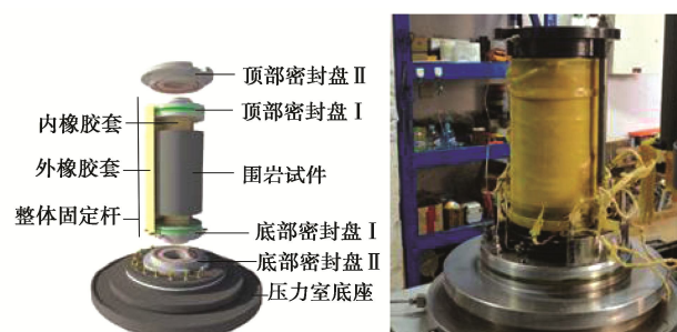
图 1 密封结构图
