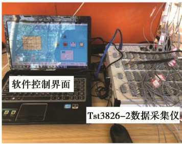
图 2 软件控制系统和 Tst3826-2 数据采集仪
