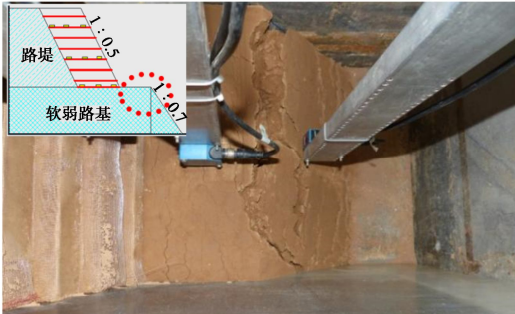
图 5 试验 T-1 地基失稳破坏 Fig. 5 Foundation failure at 60g for Test T-1
