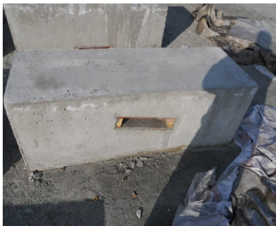
图 5 无钢筋倾斜空洞实体模型图
