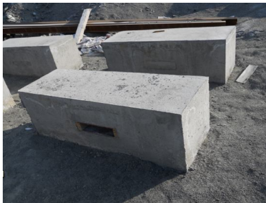
图 7 无钢筋水平空洞实体模型图
