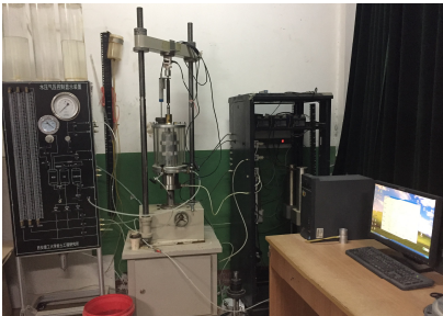
图 1 大尺寸横观各向同性试样的 K_0 预固结 Fig. 1 K_0 -preconsolidation of large-scale transversely isotropic samples
