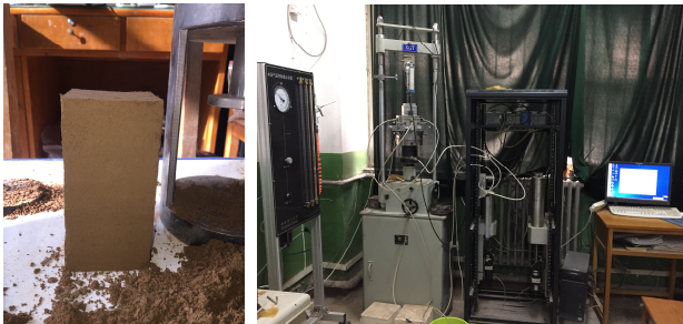
图 2 横观各向同性试样的削样及真三轴试验过程 Fig. 2 Sample cutting and true triaxial tests
