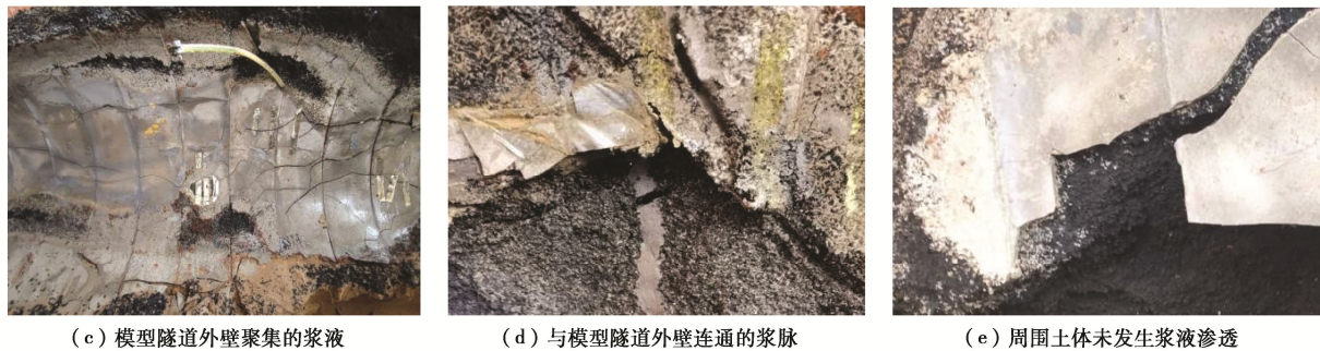
图 14 模型隧道外壁及其聚集的浆液
