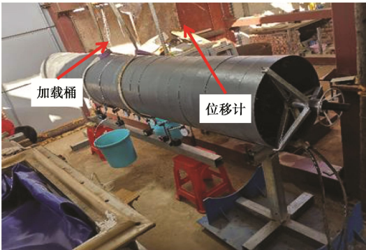
图 2 简支梁法纵向刚度测试
