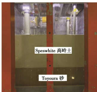
图 3 典型的离心机模型包 Fig. 3 Typical centrifuge model package
