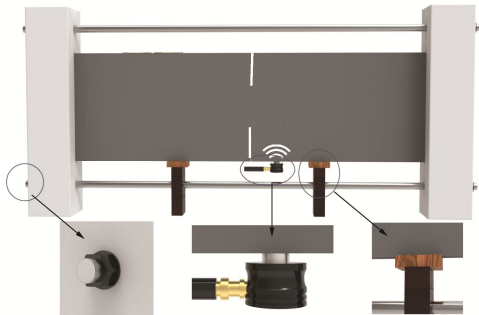
图 3 试件固定装置 Fig. 3 Fixing devices for specimens
