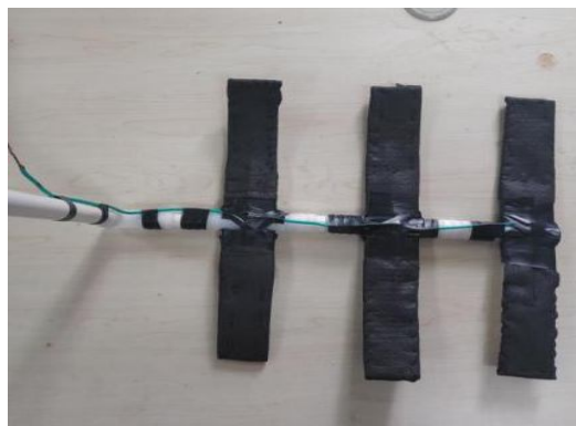
图 5 组装好的导电塑料排水板实物图 Fig. 5 Photo of conductive plastic drainage board assembled 采用石墨碳毡作为电极材料可以有效地避免电极腐蚀的情况，电极形态采用排水板可以增加电极与淤泥的接触面积，有效避免电渗后期电极与淤泥的脱开问题。导电塑料排水板可以水平布置，避免电渗后期淤泥收缩导致排水板弯折影响排水效果。排水装置本身比较轻薄可以浮在淤泥表面，可在竖直方向自由活动保证水平导电塑料排水板可以随淤泥收缩而向下移动，缩短了排水路径。
