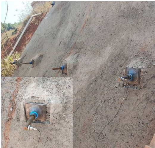
图 15 边坡锚杆工程与现场测试示意图
