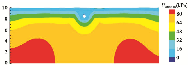
图 13 U 型碎石排水震后超孔隙水压力分布
