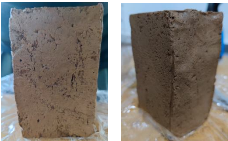
图 18 饱和黄土破坏方式 Fig. 18 Failure modes of saturated loess
