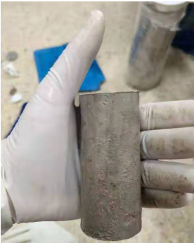
图 4 原状海洋沉积物三轴试样
