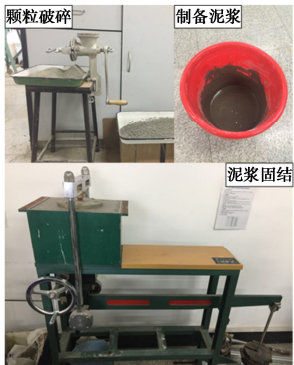
图 5 重塑样制样过程
