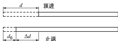
图3 顶管纵向变形图
