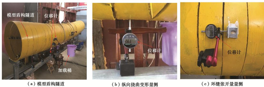
图 7 模型盾构隧道纵向刚度测试
